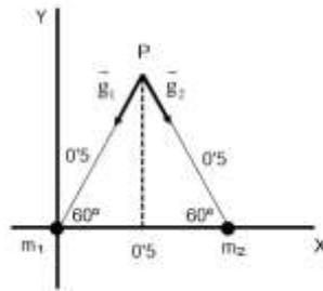
(i) Aplicamos el principio de superposición:  $\vec{g}(P) = \vec{g}_1(P) + \vec{g}_2(P)$
