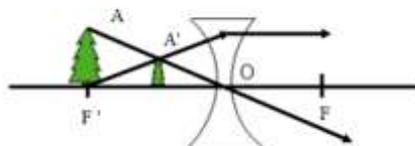
a) Responda razonadamente con ayuda de trazado de rayos: i) ¿Es posible obtener imágenes virtuales reducidas cuando colocamos un objeto delante de una lente convergente?. ii) ¿Y de una lente divergente?.
