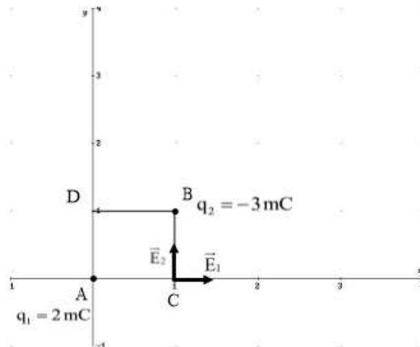
i) Aplicamos el principio de superposición:  $\vec{E}(C) = \vec{E}_1(C) + \vec{E}_2(C)$
